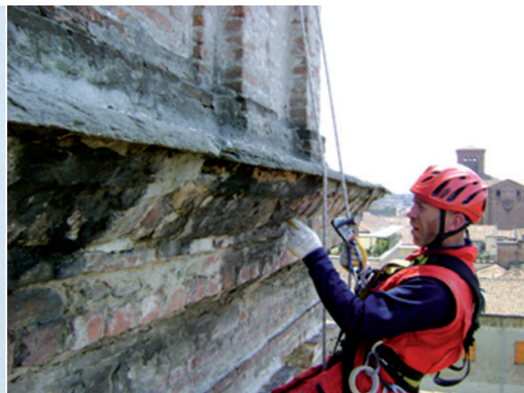
Rocciatore intento a prelevare campioni di intonaco originario esterno
