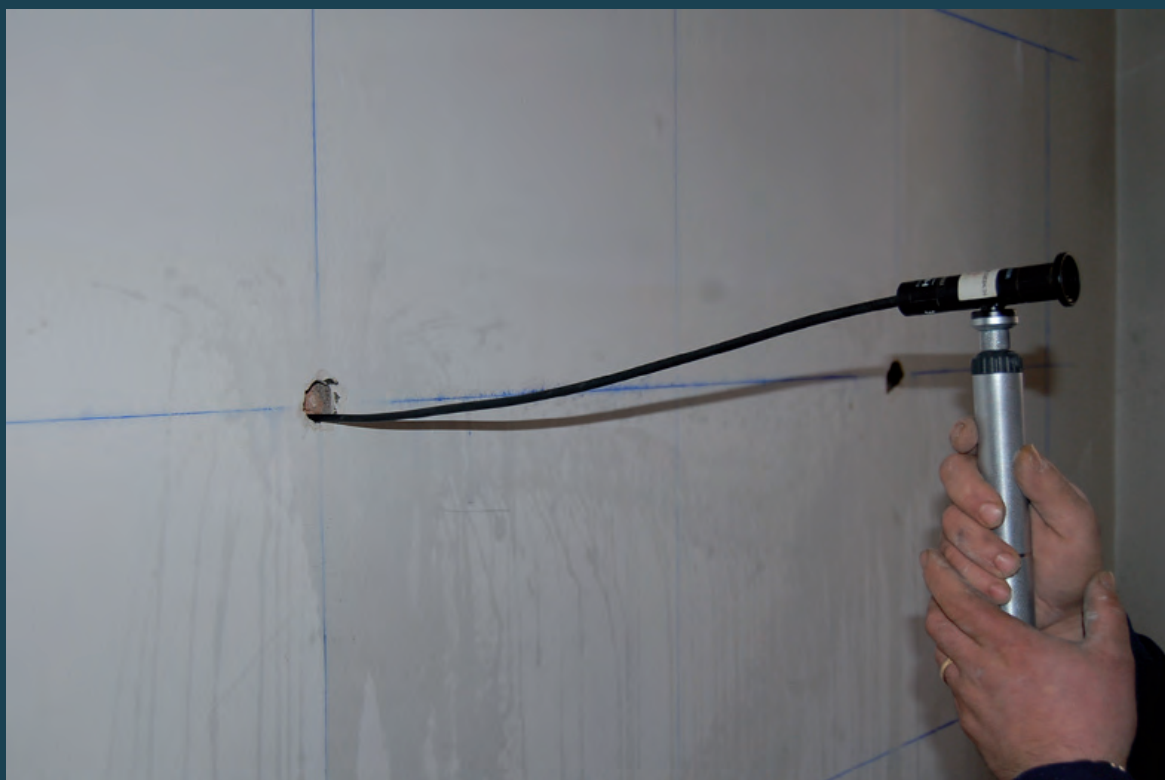
ENDOSCOPIO FLESSIBILE A FIBRE OTTICHE diametro = 0.8 cm, c.a. 30° di inclinazione
